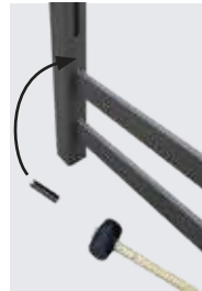
Pose des pare-closes si espacement entre les lames
